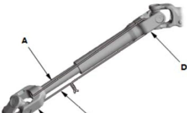
1. 在花键轴的转向节锁眼 (C) 和花键管的转向节锁眼 (D) 之间用一段钢丝 (B) 将花键轴 (A) 固定在转向柱上，以防花键轴下部被拉出。
