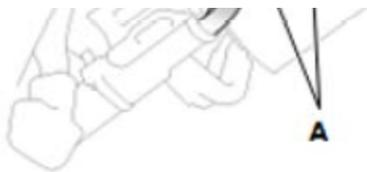
2. 从转向柱轴上拆下组合开关体总成 (A)。
